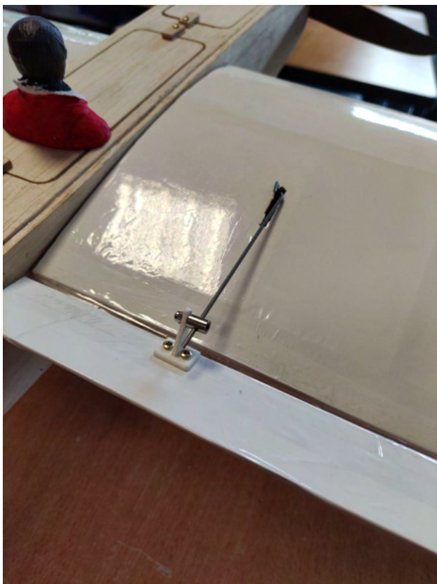
liaison mécanique entre le servo et l'aileron de l'aile droite
