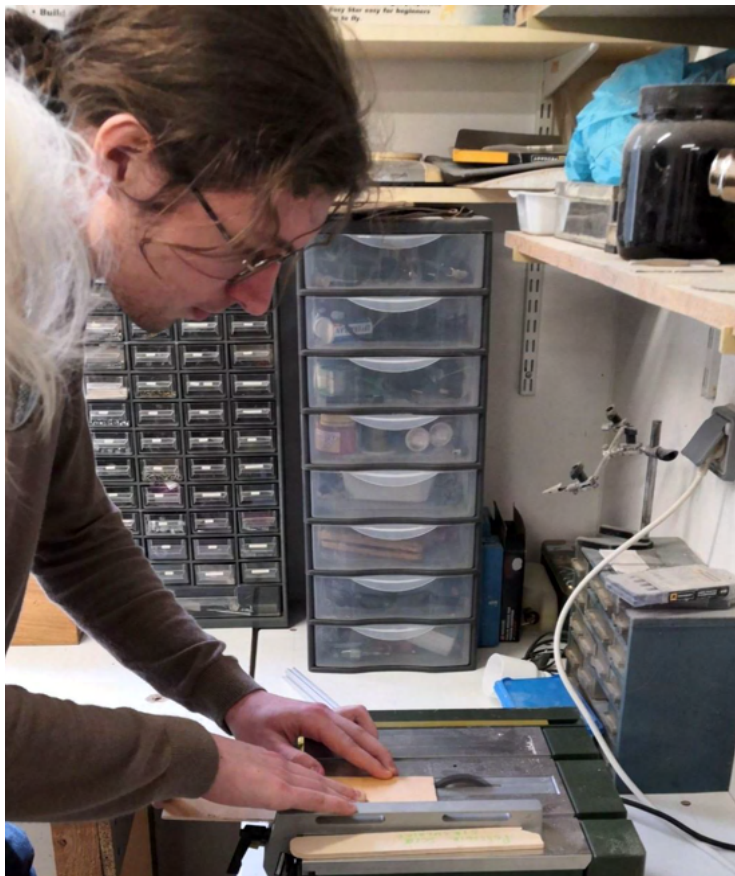
Découpage des couples sur scie circulaire
